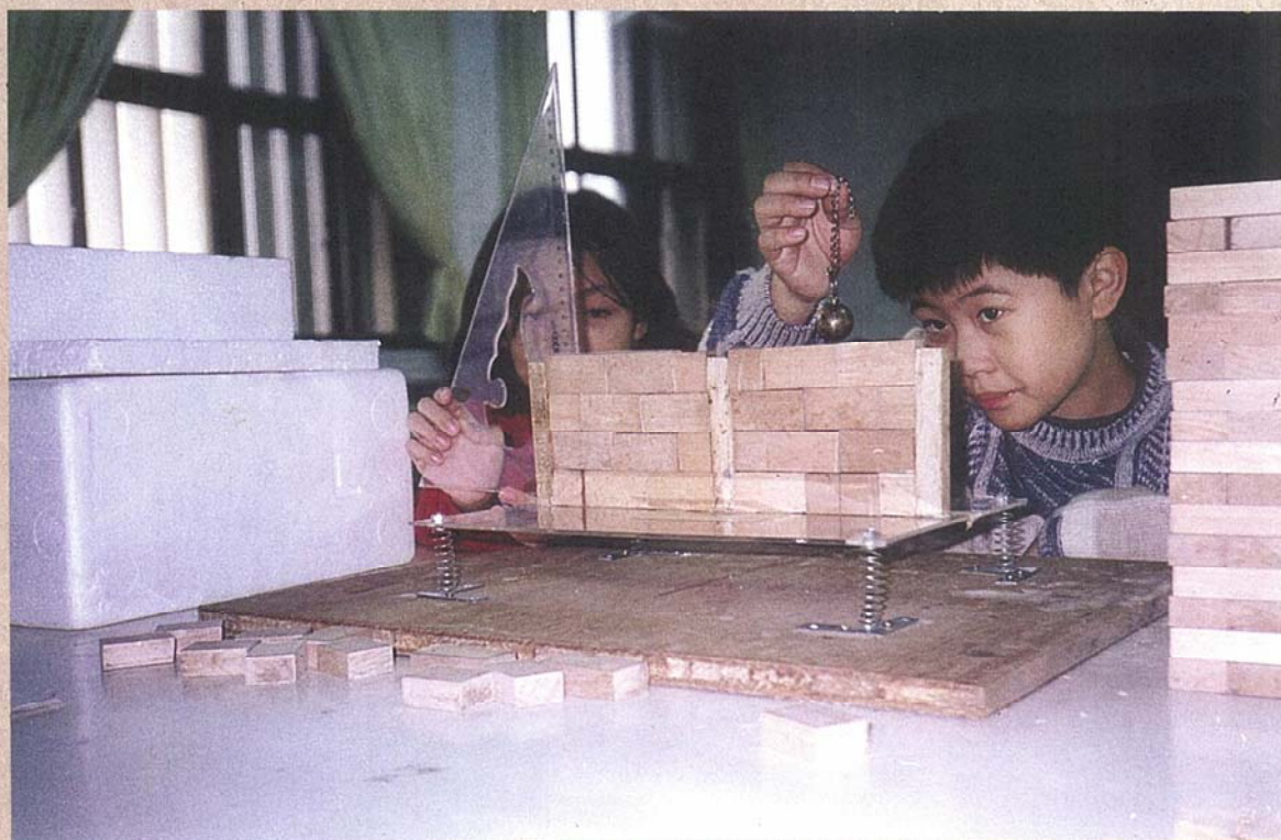
「牆不倒」作品，學生王年綺(左)、劉浩瑋(右)，在塑膠板上排出不同形狀積木，用小鐵球撞擊測出它的承受力
